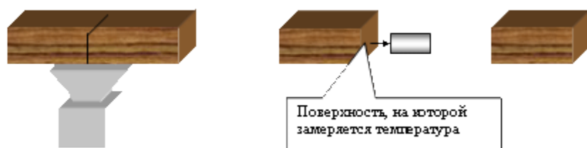
Рис. 5. Способ определения температуры внутри деревянной балки.
